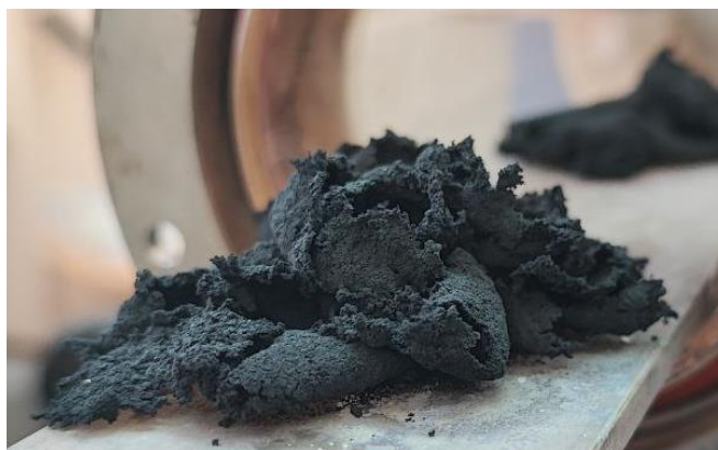
Рис. 1. Фотография углеродного продукта, полученного в реакции пиролиза метана на сплавном массивном 70Ni30Cu катализаторе при 650 °C
